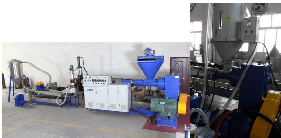
Рисунок 13 – Гранулятор с горячей резкой для полимеров модель SJ120/1(180-250кг/час).
