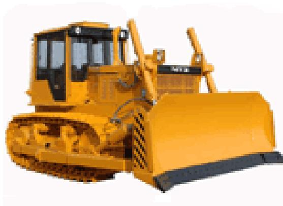
Рисунок 14 – Бульдозер Б10М (на базе трактора Т-170).
