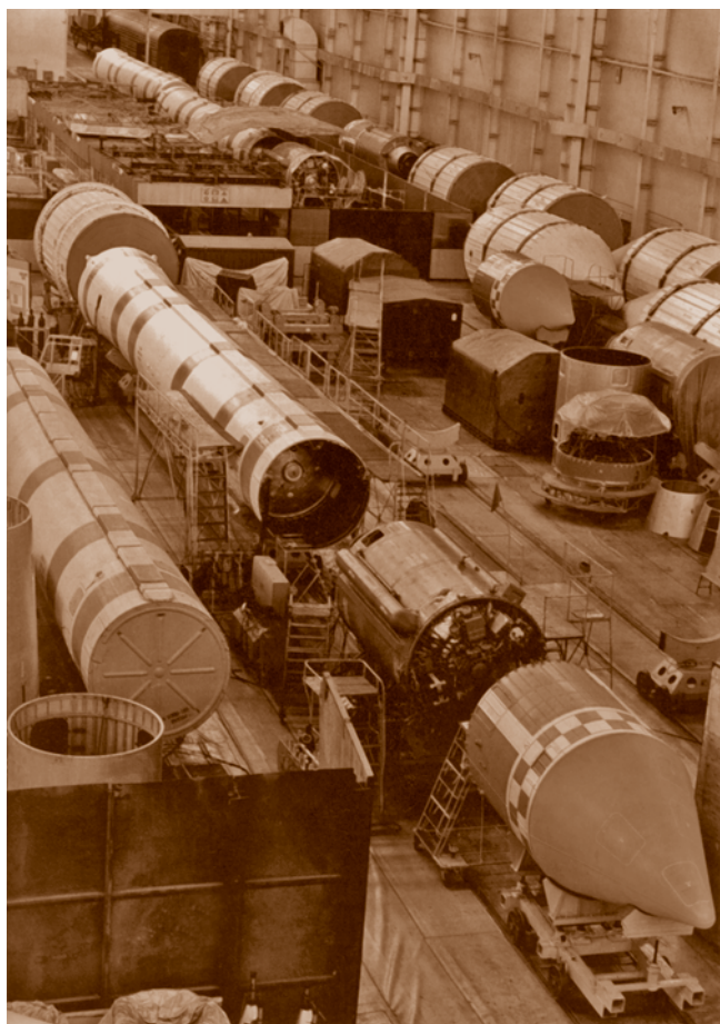
Сборка ракеты-носителя «Космос-3М»*. Серийное производство ракеты 11К65М и ее модификаций на Омском авиационном заводе началось в 1968 г.
