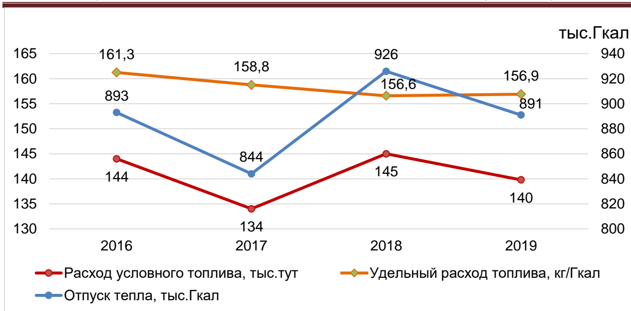
Рисунок 2.6. Динамика изменения отпуска тепла и расхода топлива собственных котельных МП г.Омска «Тепловая компания» по годам
